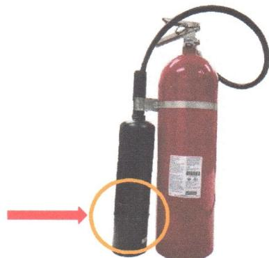
๖.๔ ตรวจสอบน้ำหนักของเครื่องดับเพลิงยกที่วัชนิดก้าชาร์บอนไดออกไซด์ (CO2) ทุกๆ ๖ เดือน โดยให้บันทึกหมายเหตุใน ทอ.พร.๐๓๐ หากน้ำหนักลดลงเกิน ๑๐ เปอร์เซ็นต์ของน้ำหนักที่ซั่งครั้งแรก โดยที่ยังไม่ได้ใช้งาน ให้ส่งคืนชย.ทอ.และแจ้งความต้องการครุภัณฑ์การผ่านระบบตามสายงาน
